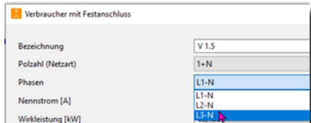
Abb. 2/4: Phasenanschluss für einen Verbraucher manuell definieren
