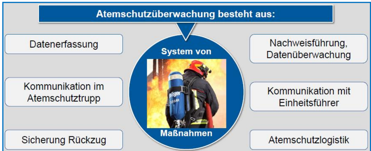
Bild 4: Die 6 Elemente der Atemschutzüberwachung.
