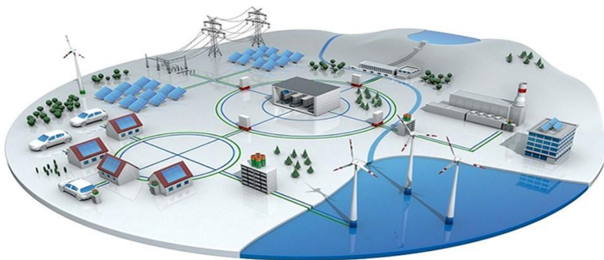
Abbildung 2-2: Paradigmenwechsel im Energieversorgungssystem: Insbesondere die Strukturen in den unteren Spannungsebenen wandeln sich zu aktiven, kleinteiligen Systemen (3M, 2018)
