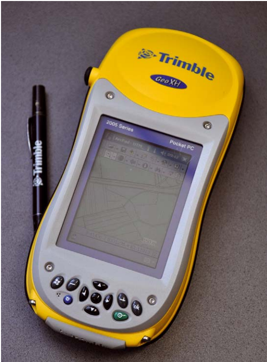
Abb. 6–7: GPS-Feldcomputer Trimble GeoXH 2005 und Holux GPS-Datalogger zur Unterstützung bei der Dokumentation in der Feldarbeit.
