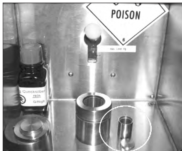
Bild 7-39 Versuchsanordnung Quecksilberporosimetrie (ANDORFER, 2007)
