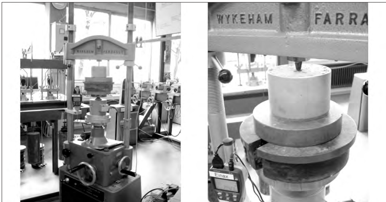
Bild 9-27: Versuchsdurchführung, links mit Proctornadel, rechts mit Konusspitze
