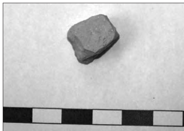
Bild 7-40 Probe ausgearbeitet zur Quecksilberporosimetrie (TA-1)
