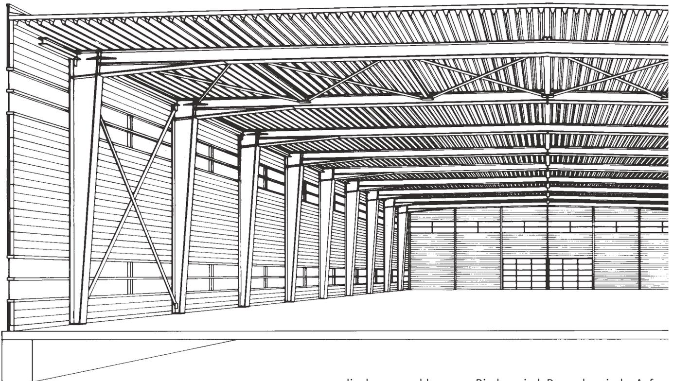
Bild 22: Beispiel Rahmentragwerk
