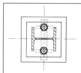
Bild 9 a: Gelenkiger Stützenfuß, leichte Ausführung mit Ankerschiene
