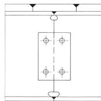
Bild 8 c: Geschweißter Längsstoß der Kranbahn im Auflagerbereich
