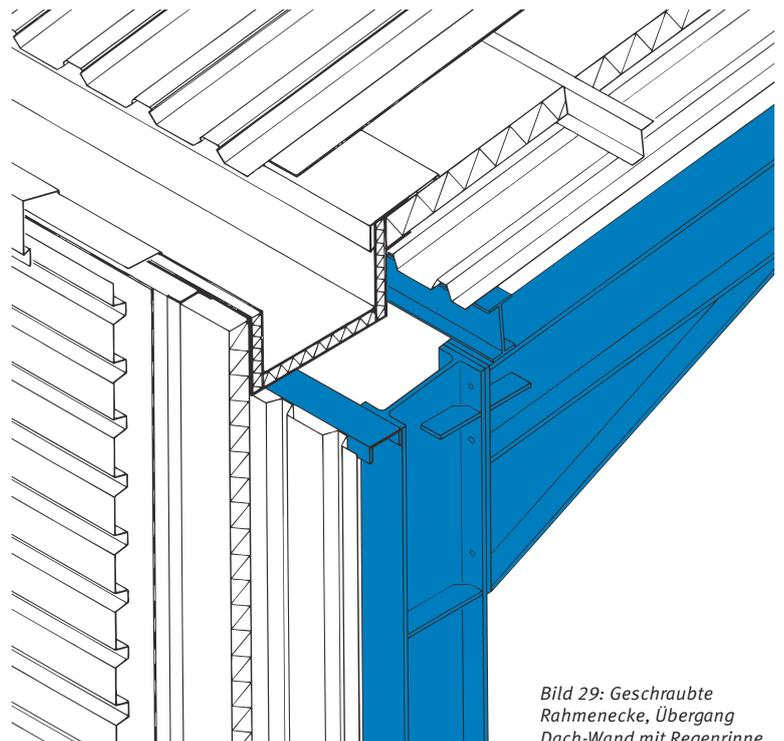
*Bild 29: Geschraubte Rahmenecke, Übergang Dach-Wand mit Regenrinne*
