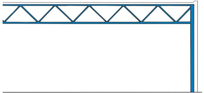
Bild 25: Zweigelenrahmen mit zweigurtigem Fachwerkriegel, Spannweite 21,00 m, Werkhalle
