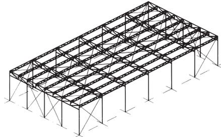
*Bild 2 c – Stützen und Binder:
