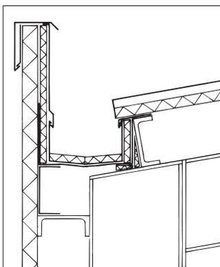
Bild 53 a: Traufpunkt mit Attika, Satteldach, PUR-Sandwichelemente
