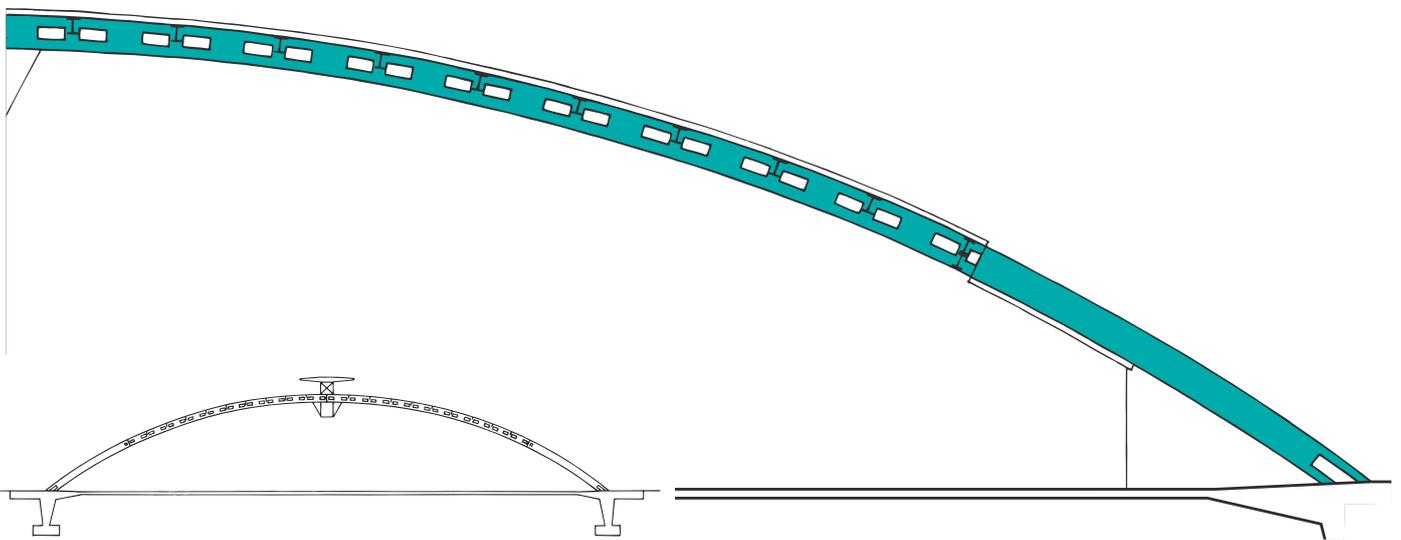
Bild 37: Zweigelenkbogen aus geschweißten Kastenprofilen mit Zugband, Spannweite 73,00 m, Messehalle Linz
