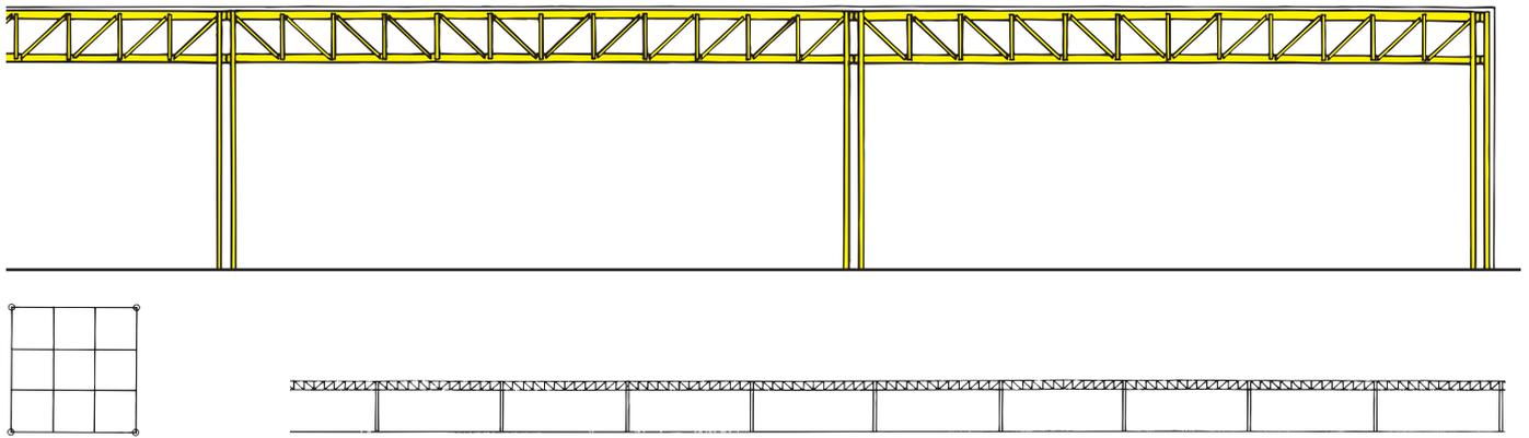
Bild 46: Mehrfeldriger Rost aus zweigurtigen Fachwerkträgern, Spannweite 15,00 m
