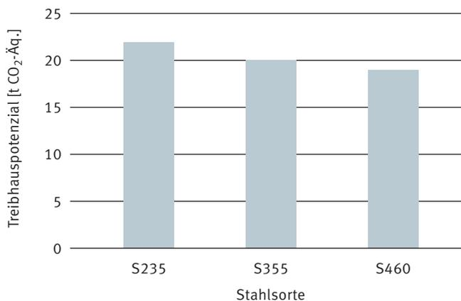
Bild 59: Mittelbarer Einfluss der Stahlsorte auf das Treibhauspotenzial am Beispiel eines Zweigelenkrahmens
