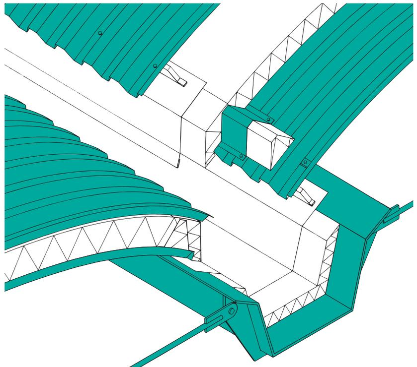
Bild 40: Aufgeständerte Bogenkonstruktion als zweischaliges Flächentragwerk (Bogendach) mit Rinnenträger und Unterspannung
