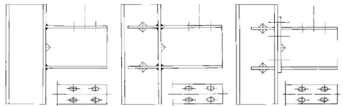
Bild 8 a: Geschweißte und geschraubte Kranbahnkonsolen aus Walzprofilen
