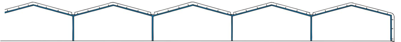
Bild 32: Eingespannte Rahmen aus Rechteckhohlprofilen, Spannweite 7,50 m
