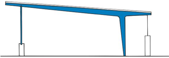
Bild 30: Einhäufiger Rahmen aus Vollwandprofilen, Spannweite 9,00 m, Schulgebäude
