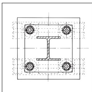
Bild 9 b: Eingespannter Stützenfuß, schwere Ausführung mit Hammerkopfschrauben und Ankerbarren
