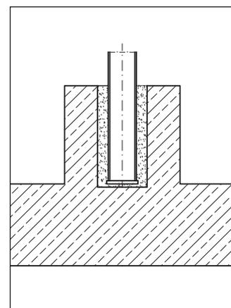
Bild 9 c: Eingespannter Stützenfuß, Hülsenfundament, Typenstatik bauforumstahl
