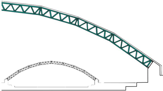
Bild 41: Eingespannter Segmentbogen aus zweigurtigen Fachwerkträgern als Bausystem, Spannweite bis zu 90,00 m
