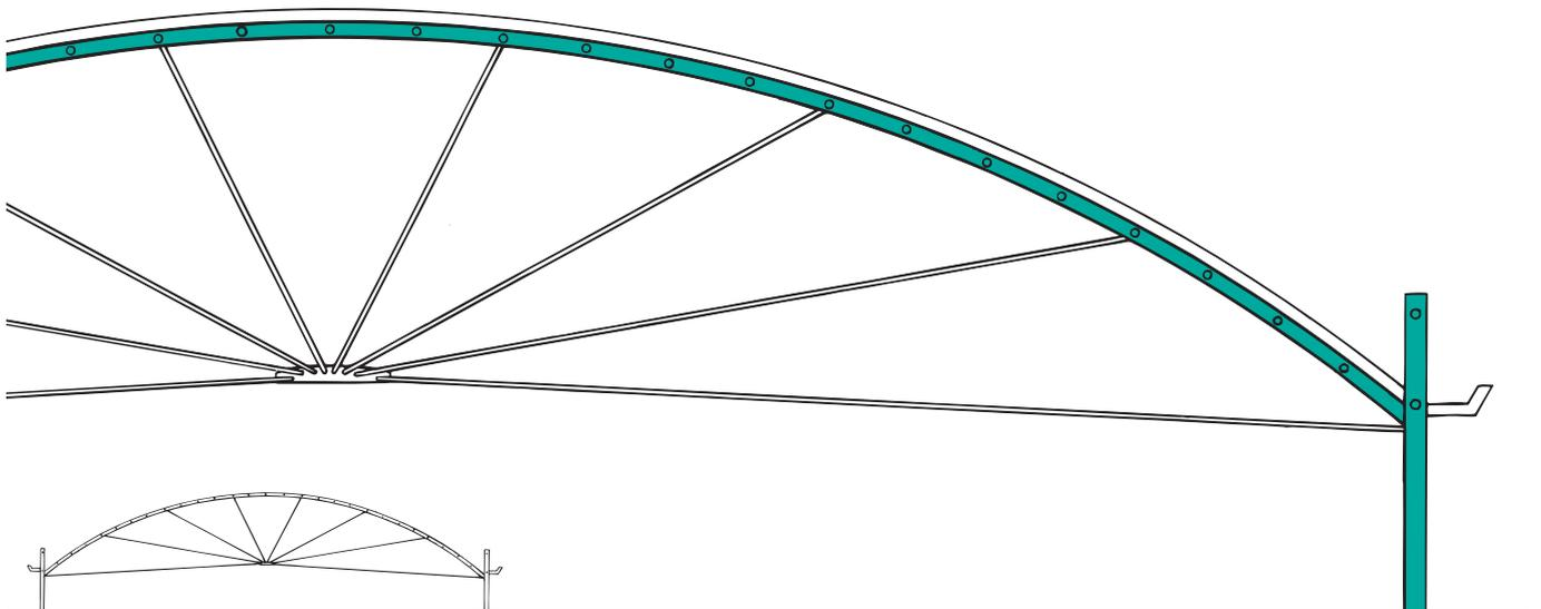
Bild 44: Verspannter Zweigelenkbogen aus Rundhohlprofilen, Spannweite 52,00 m, Postautostation, Chur
