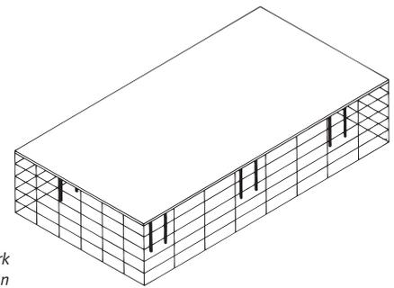
Bild 58 a: Tragwerk innen, Hülle außen
