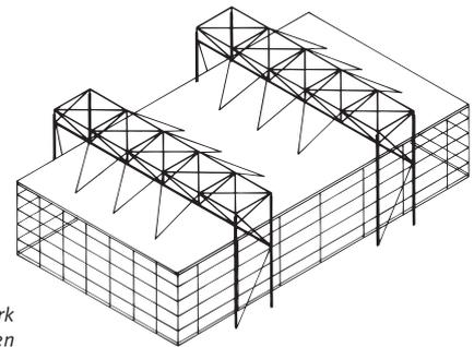
Bild 58 c: Tragwerk außen, Hülle innen
