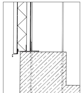
Bild 53 d: Fußpunkt, Dämmung zwischen zwei Blechschalen
