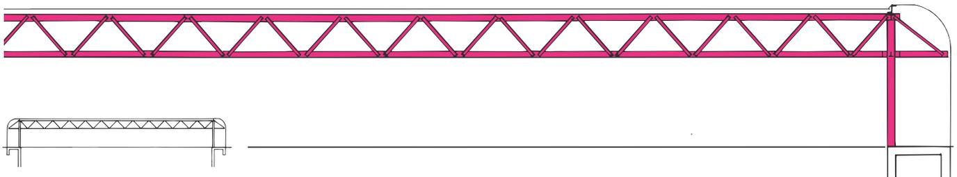
Bild 13: Binder als zweigurtiger Fachwerkträger, Sporthalle Notre Dame, Spannweite 36,60 m
