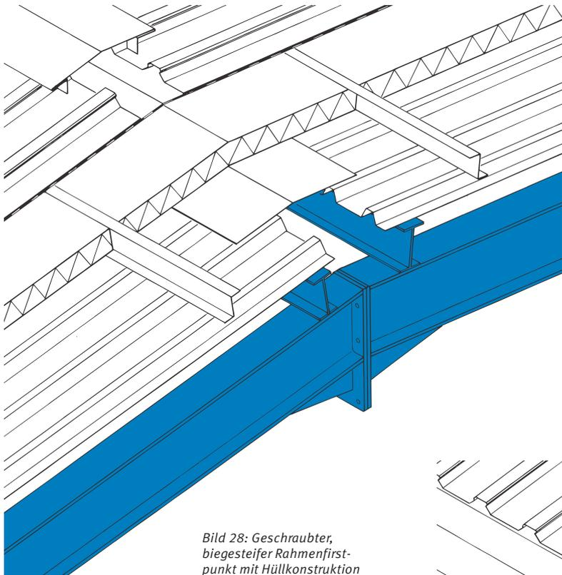
*Bild 28: Geschraubter, biegesteifer Rahmenfirstpunkt mit Hüllkonstruktion*
