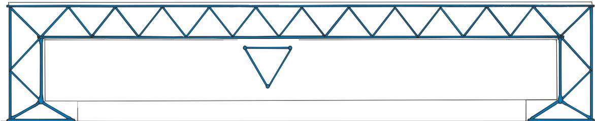
Bild 26: Eingespannter Rahmen aus dreigurtigen Fachwerkstielen und -riegeln, Spannweite 30,00 m, Möbelfabrik
