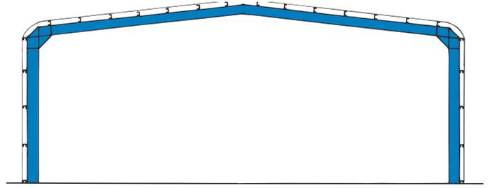
Bild 23 b: Zweigelenrahmen aus Vollwandprofilen, Spannweite 18,00 m, Lagerhalle
