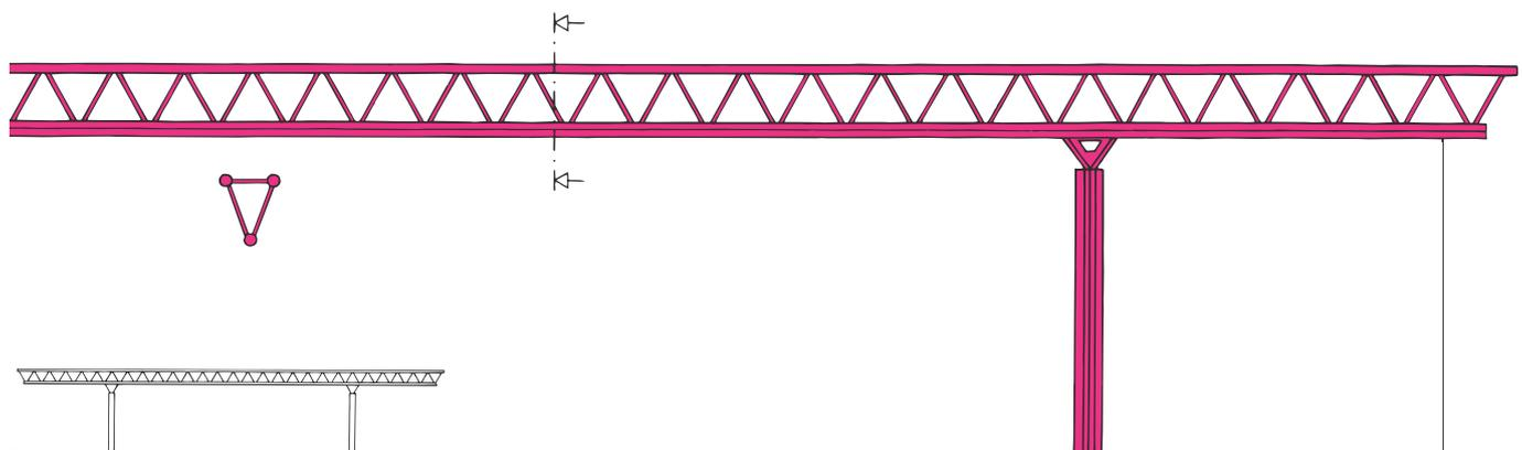
Bild 20: Binder mit Kragarmen als dreigurtiger Fachwerkträger, Spannweite 28,80 m, Gerüstbau-Halle, Echting
