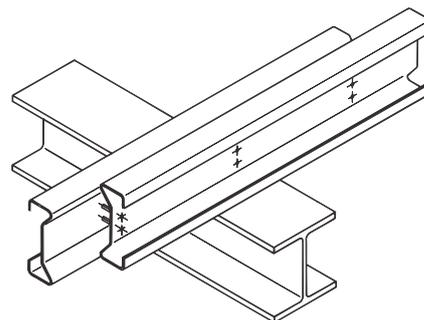
Bild 7 d: Auflagerung einer durchlaufenden Pfette aus kaltgeformtem Sonderprofil
