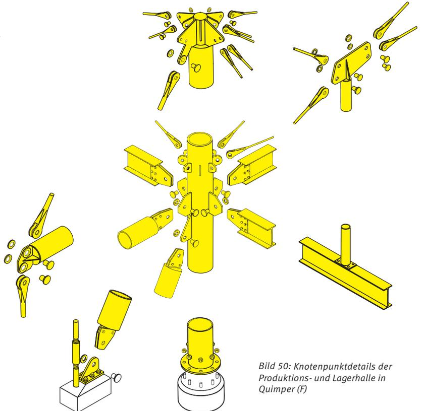
Bild 50: Knotenpunktdetails der Produktions- und Lagerhalle in Quimper (F)
