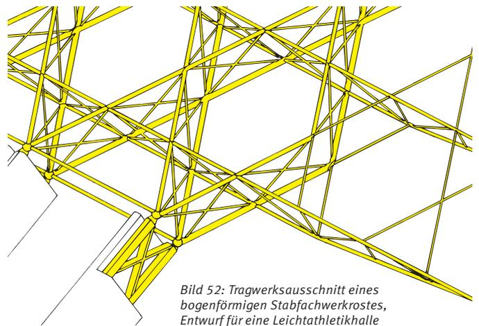
Bild 52: Tragwerksausschnitt eines bogenförmigen Stabfachwerkrostes, Entwurf für eine Leichtathletikhalle
