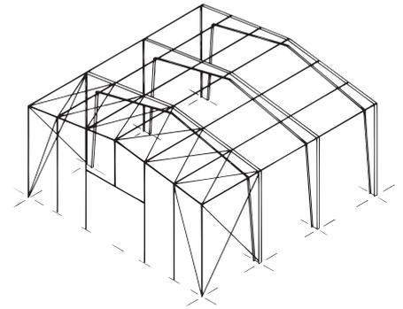
Bild 6 a: Längsaussteifung einer Rahmehalle mit Keuzverbänden und tragender Giebelwand im Endfeld
