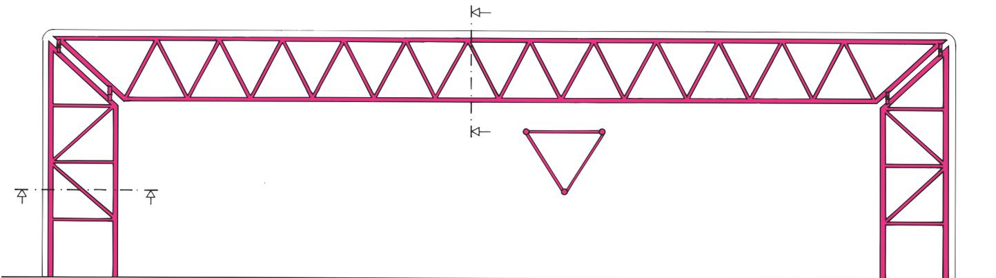
Bild 14: Binder als dreigurtiger Fachwerkträger, Sainsbury Center, Norwich, Spannweite 29,30 m
