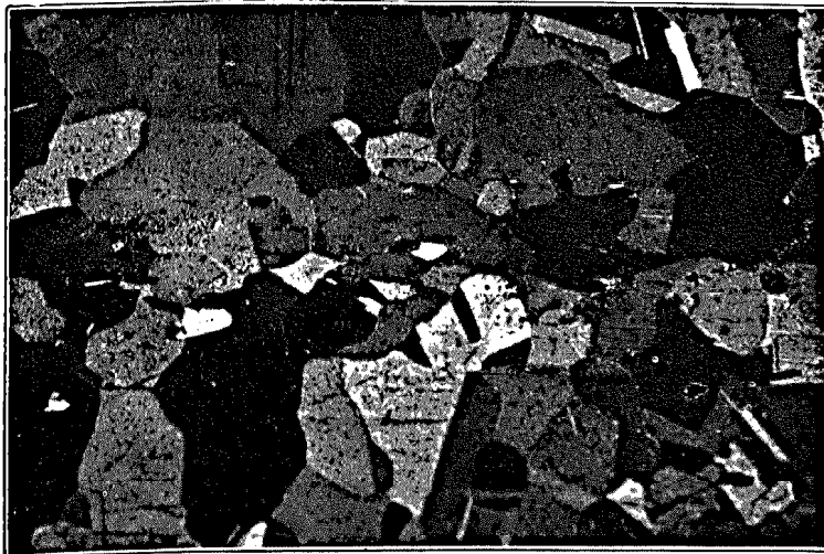
Abbildung 2. Kristallfelder-Aetzung. \alpha -Messing; die einzelnen Kristalle werden infolge ungleicher Oberflächen-Reflexion durch Helligkeitsunterschiede angezeigt. Geätzt mit 10prozentiger Ammoniumpersulfatlösung.
