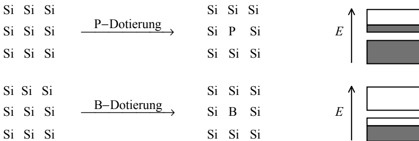
Abb. 3.1.4-2. Phosphor- und Bor-Dotierung von Silicium; n- und p-Halbleiter
