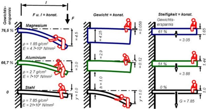
**Bild 1.1:** Veranschaulichung des Leichtbaupotenziales von Aluminium [6].
