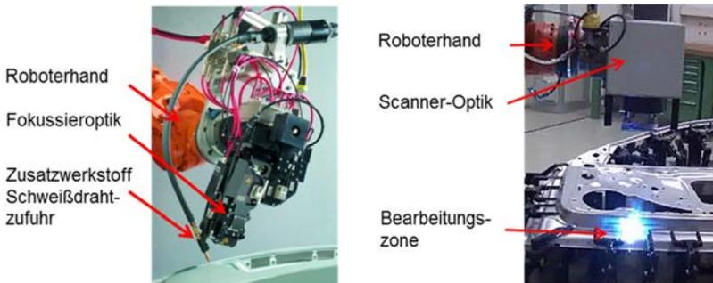
**Bild 1.2:** Links: Taktill geführtes Laserstrahlschweißen mit Zusatzwerkstoff [13].
