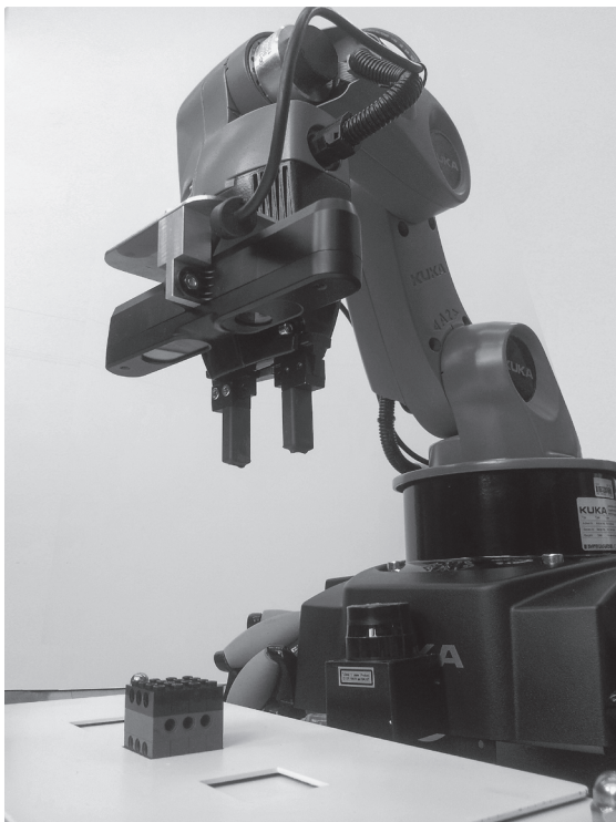
Lokalisieren und Greifen des Objekts mit dem Roboterarm
