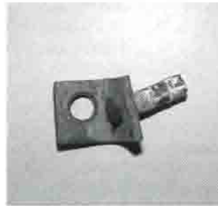
Ein herausgerissener Bohrhaken und ein gebrochener; beide Größe M8 (zu klein, nicht rostfrei und von falscher Konstruktion)
