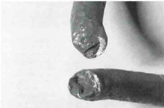
Eine bis auf wenige Quadratmillimeter (blanke Stelle) durchgerostete Schweißnaht eines Ringhakens (Standhaken aus dem „Gelben U“ am unteren Berggeistturm, Wetterstein)
