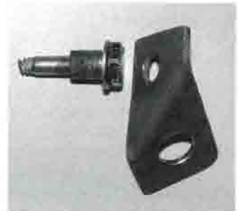
Links: Eine selbstgebastelte Bohrhakenlasche mit zu kurzer Schraube; bei Sturzbelastung Ausbruch des Gewindes, das nur zwei (!) Gewindegänge gegriffen hatte. Rechts: Ein durch Sturz gebrochener Industrie-Anker, dessen Schraube nicht fachgerecht (zu stark) angezogen und damit schon beim Setzen geschädigt worden ist (deutlich zu erkennen an der Einschnürung des Gewindes)
