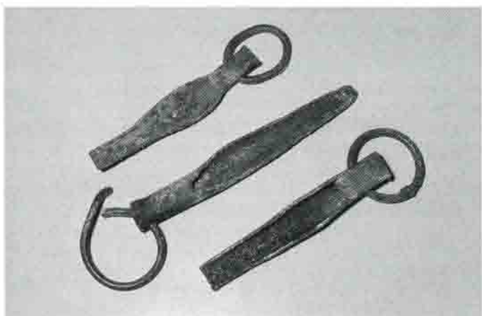
Linkes Bild: Self-made-Haken aus Vierkant- und Wasserleitungsrohr. Rechtes Bild: links zwei Self-made-Haken aus dem Bayerländer-Riß (Ruchenköpfe), die unterhalb der Schlüsselstelle (VI-) steckten; rechts zwei Schloßschrauben aus der Via Tyszkiewicz (Arco). Die Linie zeigt, wie weit die Haken im Fels steckten
