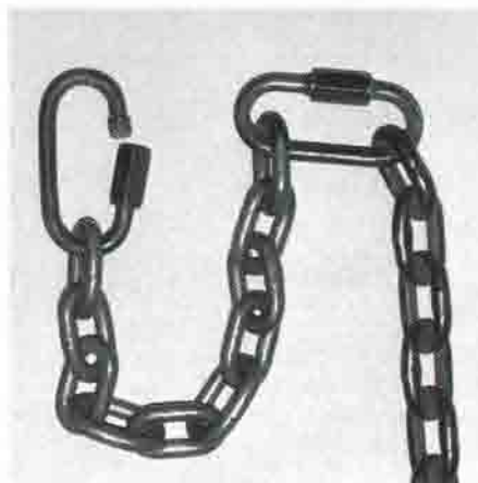
Schrott, der aus einer Route geholt wurde; der obere rechte Haken ist eine Holzschraube (!); bei der Kette deutlich zu erkennen das offene Kettenglied
