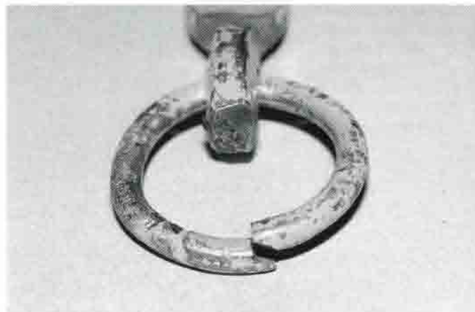
Links: Von der Größe des Ringes läßt sich selten auf die Länge des Schaftes schließen. Rechts: Ein Ringhaken, der im Fels so vorgefunden wurde (miserable Schweißnaht), der Ring wurde zum Fotografieren nur etwas aufgebogen
