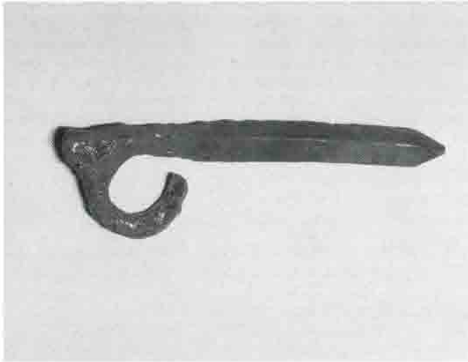
Ein Bilderrhaken (!), der viele Jahrzehnte (Rost) als Zwischensicherung diente
