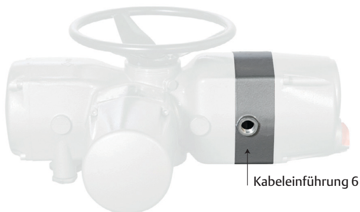
Abbildung B-6 Grundantrieb mit Verlängerung [A] am Steuerungsteil
