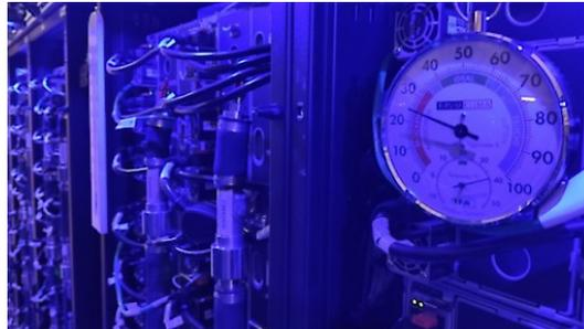
*Rund 40 Grad hat es im Inneren des VSC-4. Die Luftfeuchtigkeit wird genauestens überwacht. (Bild: Dominik Erlinger)*
