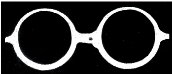
Bild 1: Beispiel für hohe Korrosionsdynamik an Verdampferwänden in Biomasseverbrennungsanlagen. Befund vor Ort und Abzehrungscharakteristik
