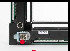
Die neuen robusten, feuchtigkeitsgeschützten **Steckverbindungen** am Messrahmen sind auch für den Einsatz im offenen Schießstand geeignet.
