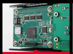
Der neue **Controller** ist ein moderner Single-Board PC mit Betriebssystem Embedded Linux.
