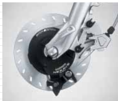
BR-IM75-F travão de roletos dianteiro para montagem nos apoios de travão disco (Tipo-A internacional)
