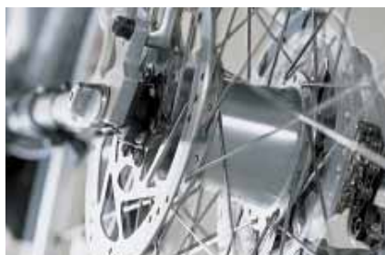
NEXAVE C810 : Auto-alimentado por cubo dínamo livre (FH-C811)
