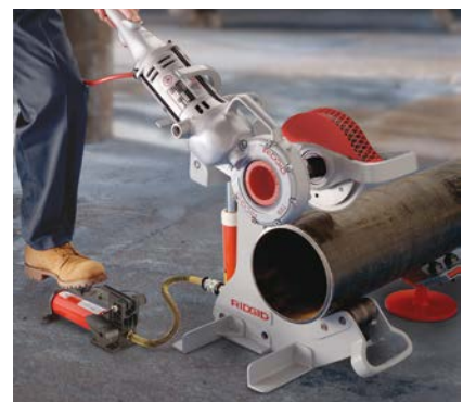
Elektro-Rohrabschneider Modell 258 mit Kraftantrieb Modell 700 beim Schneiden
