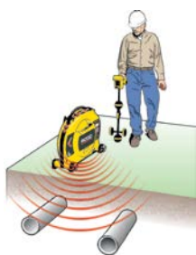
Induzieren eines Signals zur Lokalisierung von Versorgungsleitungen.
