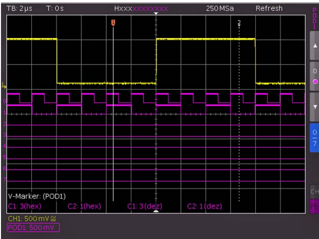
Abb. 11.1: Einstellungen der Logikkanalanzeige
