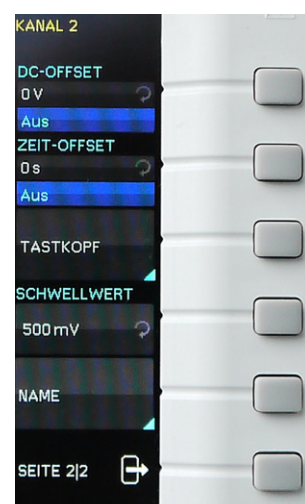
Abb. 2.10: Softmenügrundelemente Einstellung und Navigation
