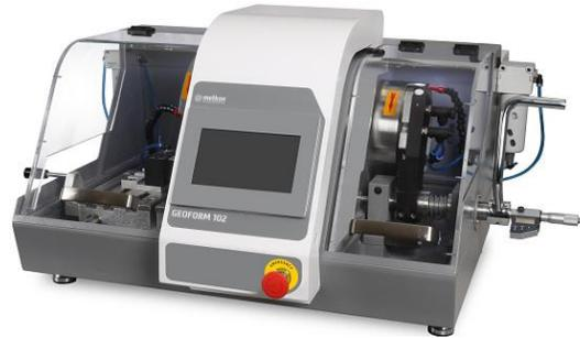
GEOFORM - Präzisions-Dünnschnitt-Trenn- und Topfstein-Schleifmaschine
