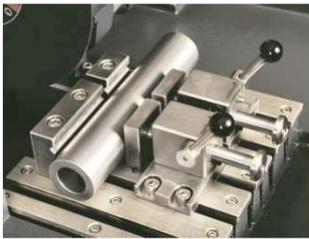
großer Trennraum zum Trennen großer Prüfstücke
