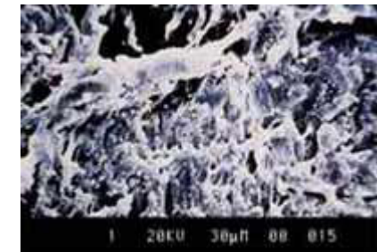
Oberfläche einer Kunststoffprothese nach 1 Jahr Tragedauer.
