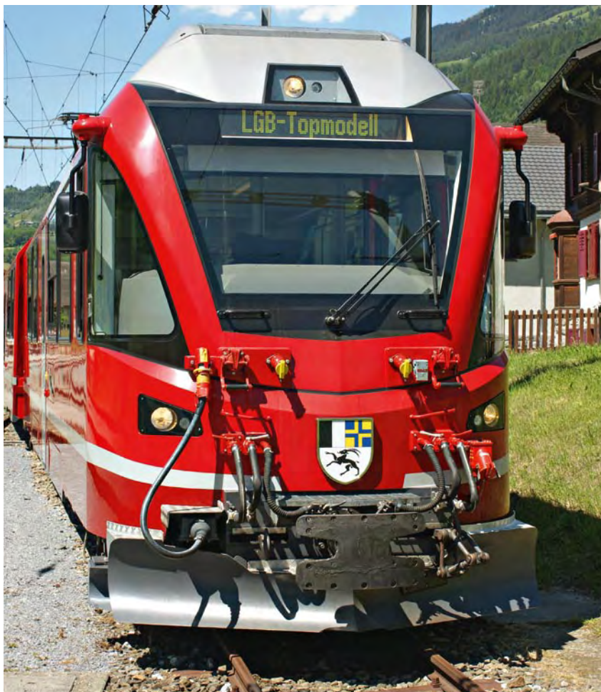
Alleskönner: Das Paradeferd der RhB fährt sowohl mit Gleichstrom als auch mit Wechselstrom und kann den Stromsystemwechsel fahrend durchführen. Dank seiner Leistungsstärke ist der Allegra zudem in der Lage, Güter- oder Spezialwagen zu ziehen.
