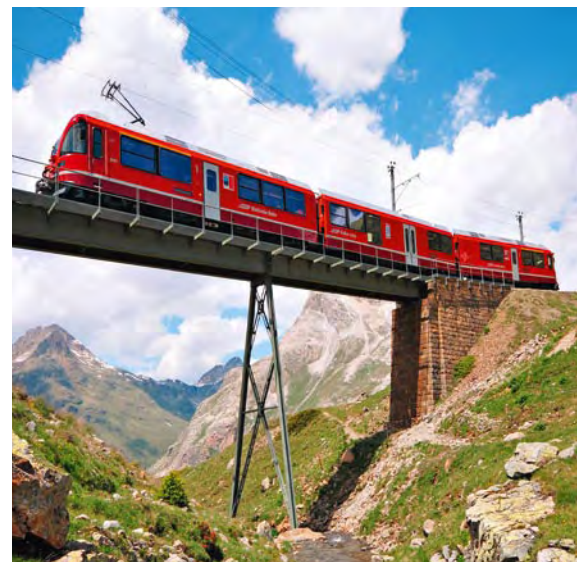
Alleskönner: Das Paradeferd der RhB fährt sowohl mit Gleichstrom als auch mit Wechselstrom und kann den Stromsystemwechsel fahrend durchführen. Dank seiner Leistungsstärke ist der Allegra zudem in der Lage, Güter- oder Spezialwagen zu ziehen.
