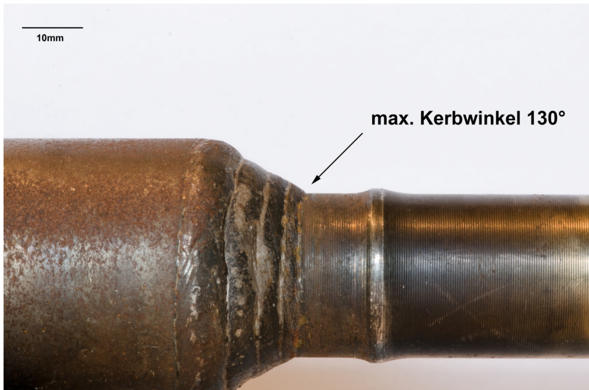
Abbildung 13 – Schweißübergang mit Spitzkerb
