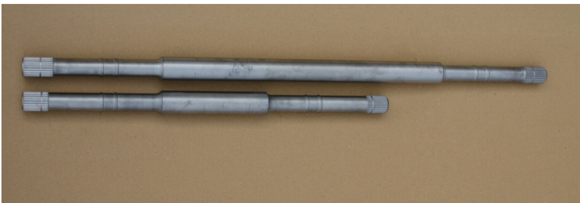
Anhang 12 – Fertige Antriebswellen nach dem Nitrieren
