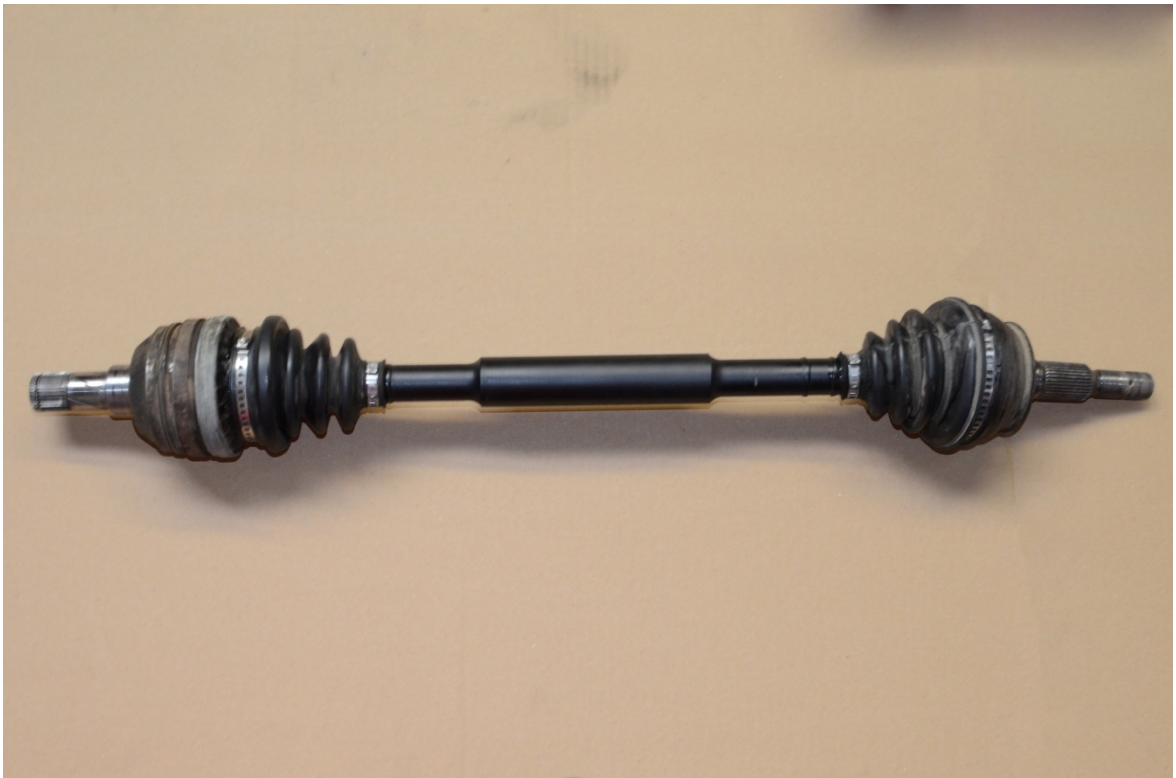
Anhang 12 – Fertige Antriebswellen nach dem Nitrieren
