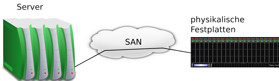
Abbildung 1.2: Mehrere Server mit gemeinsamem Speicher
