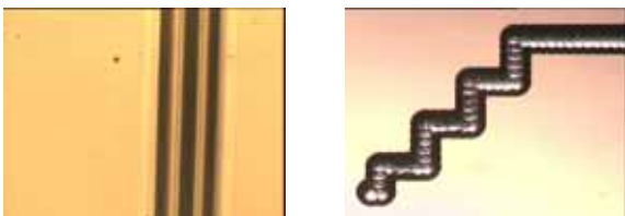
Bild 4: Lichtmikroskopische Aufnahmen eines laserstrukturierter Grabens (links) und eine Struktur, die mittels CNC-Fräse in die Glasoberfläche eingearbeitet wurde (rechts). In beiden Fällen wurde D263T-Dünnglas als Substrat verwendet.
