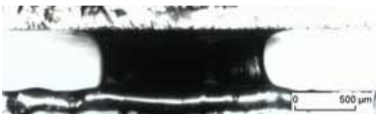
Bild 6: Querschnitt an den Stirnflächen zweier Dünngläser, welche mit einer strukturierten Schicht aus polymerfreien Siloxanklebstoff gefügt wurden. In der Mitte ist Schwarz gefärbt der Kleber zu sehen, links und rechts befinden sich die fluidischen Kanäle.
