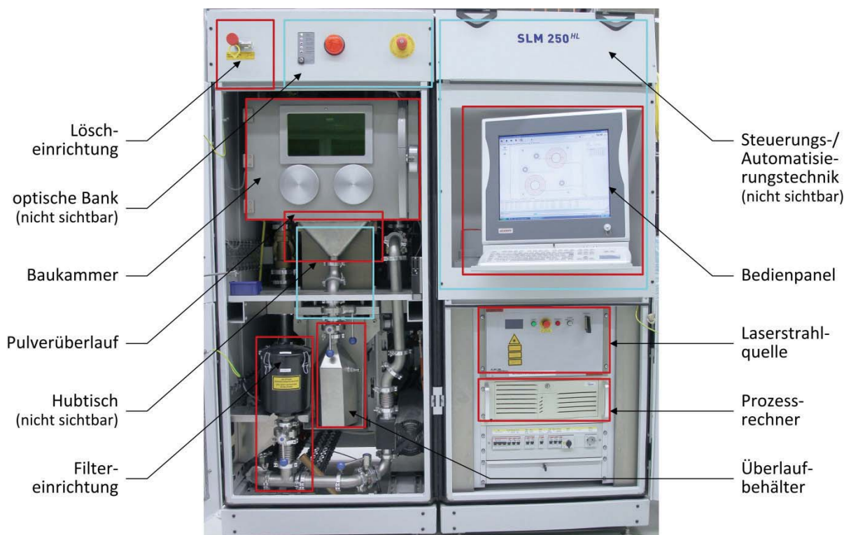
Abbildung 3.2: Komponenten der industriellen Fertigungsanlage SLM 250HL
