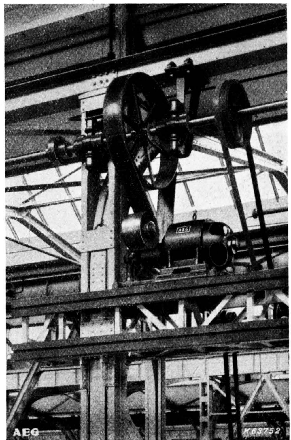
Bild 2. Antrieb einer Transmissionswelle durch einen Drehstrom-Asynchronmotor mit Kurzschlußläufer.
