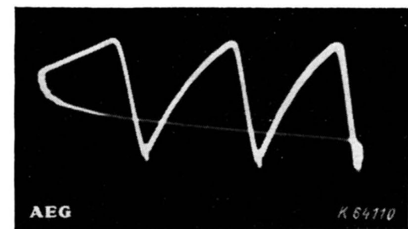
Bild 27. Kippspannungskurve wie Bild 26 mit weitergesteigertem Ladestrom durch Erhöhung der Schirmgitterspannung. f_K = 173,5 kHz; I_L = 93 mA; R_K = 0 ; U_B \approx 200 V; \tau_R = 78\% .
