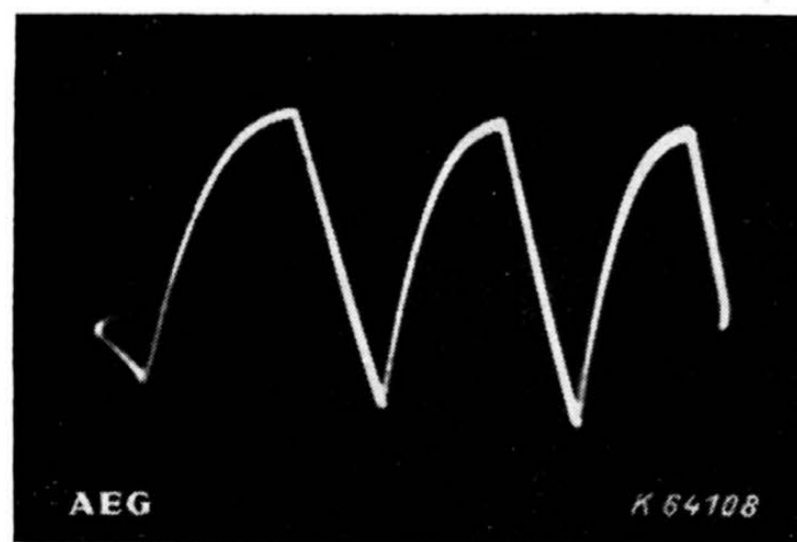
Bild 25. Kippspannungskurve bei normaler Kippschaltung nach Bild 9 und bei größtmöglichem Ladestrom. f_K = 48,1 kHz; Kippkapazität C = 3000 pF; I_L = 54 mA; R_K = 66 \Omega ; U_B \approx 250 V; \tau_R = 49\% .
