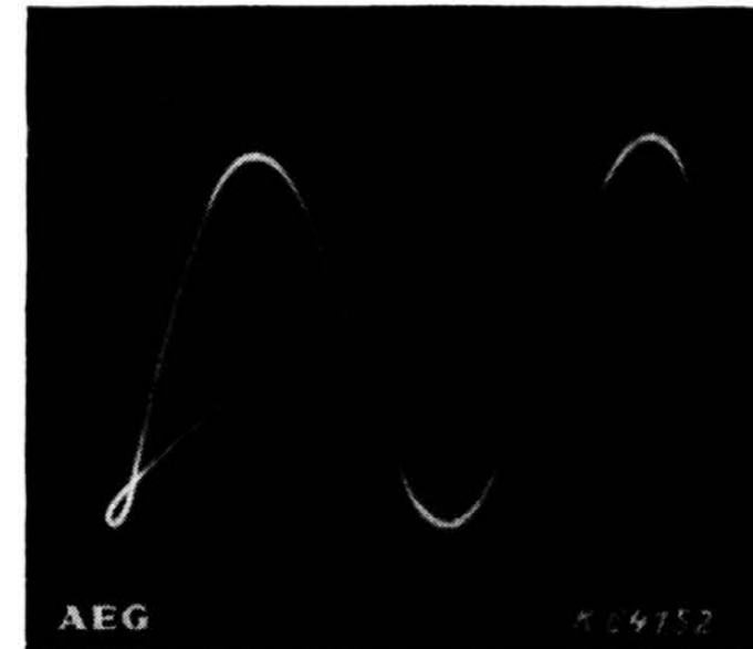
Bild 8. Oszillogramm einer Senderspannung. Meßfrequenz f_M = 2 MHz, Kippfrequenz f_K = 1 MHz (Pieplow).
