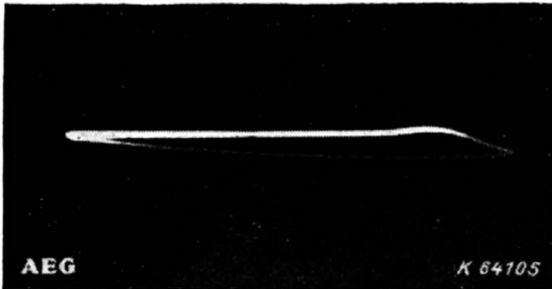
Bild 22. Oszillogramm einer Spannung am Steuergitter der Laderöhre in einer Anordnung nach Bild 21 in Abhängigkeit von der Anodenspannung. f_K \approx 0,8 MHz; I_L = 15,5 mA.
