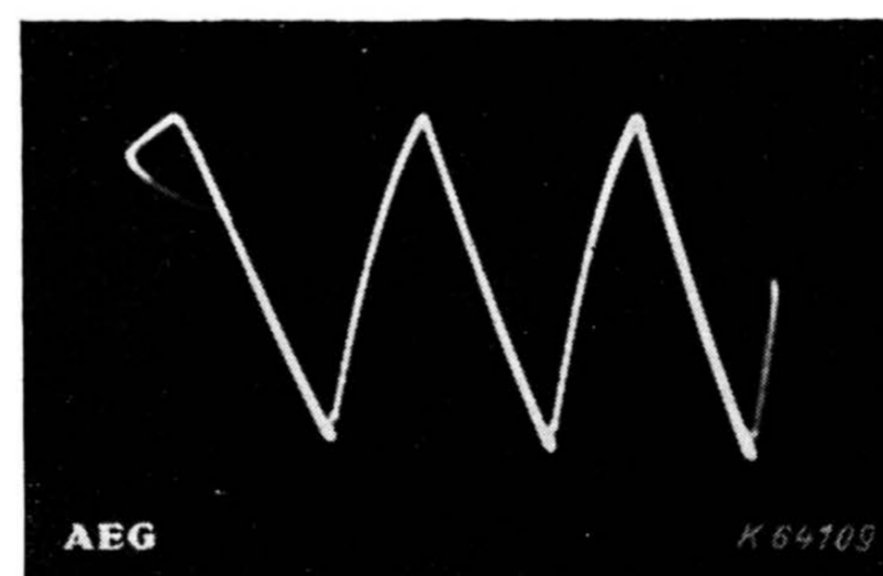
Bild 26. Kippspannungskurve wie Bild 25, jedoch mit Verriegelung der Laderöhre nach Bild 21, f_K = 98,5 kHz, I_L = 51 mA; R_K = 0 \Omega ; \tau_R = 38\% .
