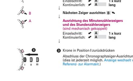
**Ausrichtung des Minutenzählerzeigers**
