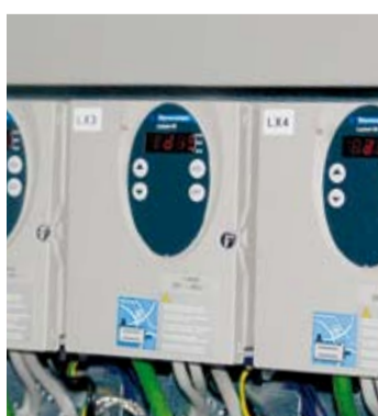
Servoverstärker bringen den Hexapoden zum Steppen.
