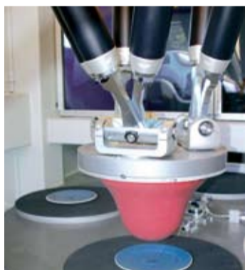
Ein Hexapod steuert den Tampon, der die Keramik bedruckt.
