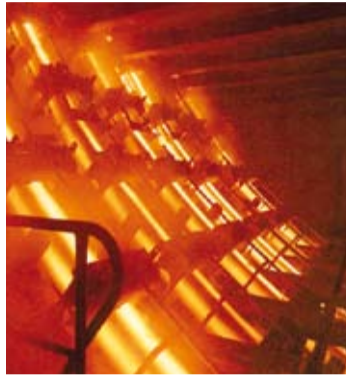
Eine Stranggussanlage in vollem Betrieb.
