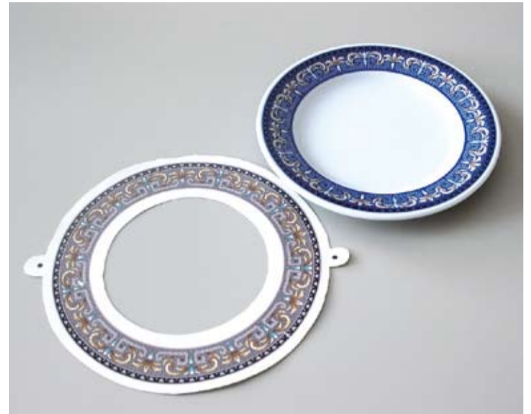
Mit der von data M Engineering entwickelten Maschine können Dekore (im Vordergrund) wie Abziehbilder auf Teller oder Fliesen aufgebracht werden.
