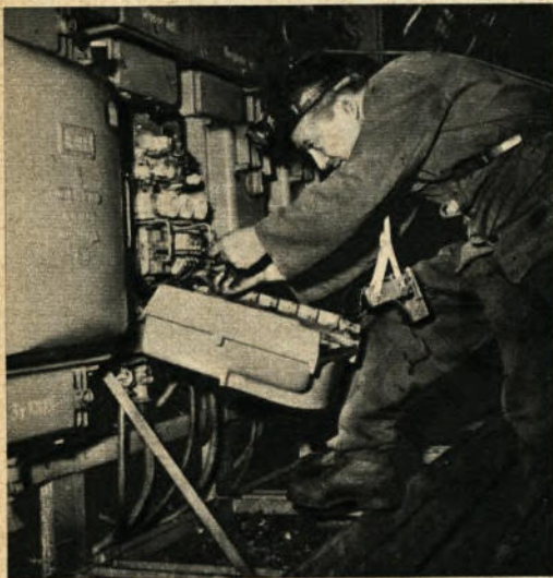
▲ Wichtig ist die ständige Beobachtung der elektrischen Verteileranlagen. Auf unserem Bilde überprüft Elektrohaue Karl Rappe ein Motorsteuergerät auf der 8. Sohle
