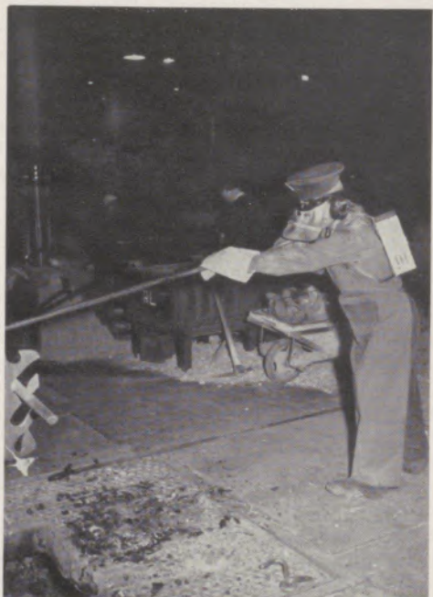
Abb. 3 Schmelzer Herbert Dornfeld mit Pulszähler vor dem Lichtbogenofen
