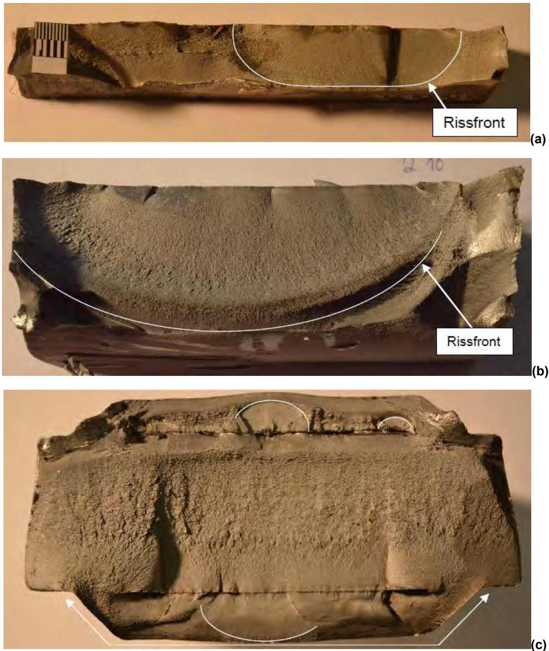
Bild 7-19: Bruchflächen: Rissfronten im Grundblech: PK 2.1 (a), PK 2.10 (b), Rissfronten in die Schweißnaht bei Wurzelversagen: PK 3.6 (c)
