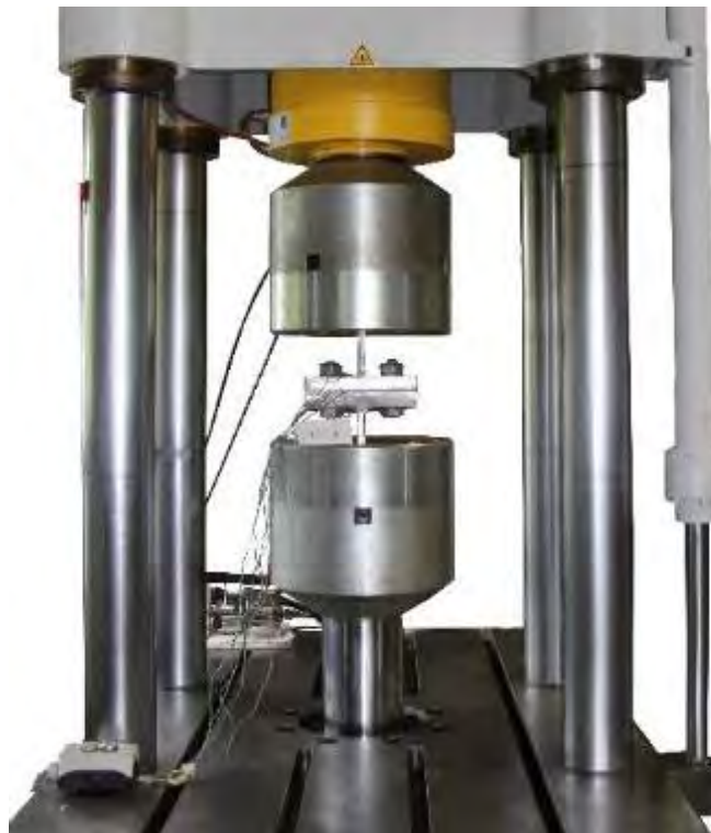
Bild 8-12: 4-Säulen-Prüfmaschine für Kleinprobekörper mit eingebautem Probekörper TC
