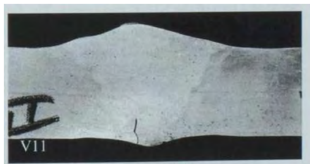
Bild 6-66: Bruchstelle in einseitig geschweißtem Stumpfstoß (Quellen ID: #308)
