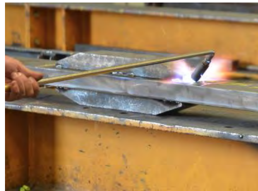
Bild 7-11: Schweißvorbereitungen: angeheftete Gurtlamellen (o.l) und (o.r.), Skizzieren der Schweißnahtgeometrie (u.l) und vorwärmen (u.r.)
