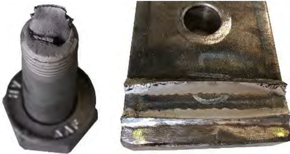
Bild 8-16: Typische Versagensbilder der Serie LA: Schraube (links) und Schweißnahtwurzel (rechts)
