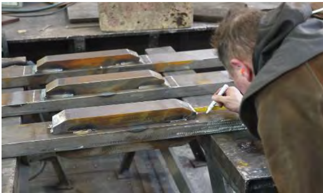
Bild 7-11: Schweißvorbereitungen: angeheftete Gurtlamellen (o.l) und (o.r.), Skizzieren der Schweißnahtgeometrie (u.l) und vorwärmen (u.r.)
