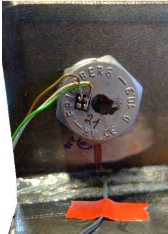
Bild 25-9: Messschraube DMS 5 eines Großprobekörpers Figure 25-9: Measurement bolt DMS 5 of a large-scale specimen
