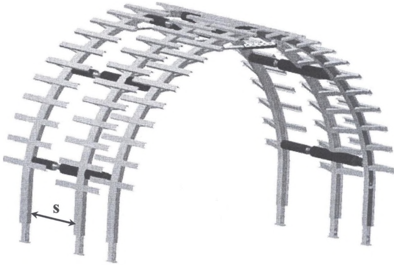
Rys. 9. Widok zestawu obudowy tymczasowej podczas przemieszczania do czoła przodka jednego z segmentów Fig. 9. View of set of new solution of self-advanced drift support during moving of one of segments
