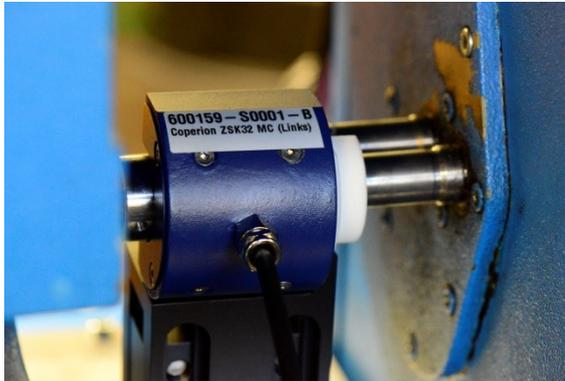
Abbildung 3.14: Schneckenwellenaufnahme des Getriebes mit Sensor
