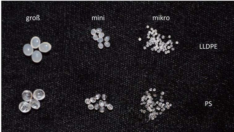
Abbildung 3.17: Kugelgranulate, oben LLDPE und unten PS
