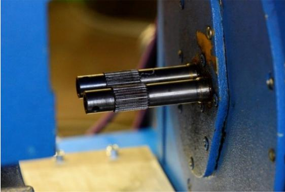
Abbildung 3.12: Schneckenwellenaufnahme des Getriebes des ZSK32
