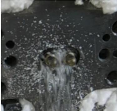
Abbildung 3.3: Herausfördern des Granulates ohne Rückstau
