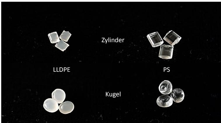
Abbildung 3.18: Vergleich Kugel und Zylindergranulate
