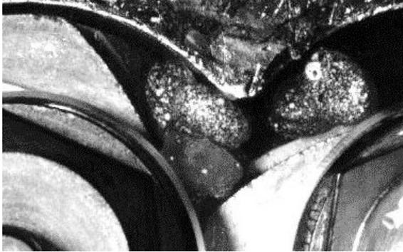
Abbildung 6.3: Oberer Zwickelbereich mit besprenkeltem Granulat
