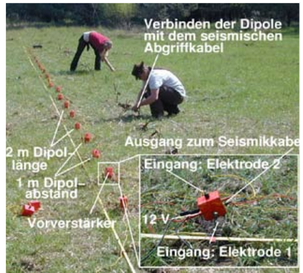
Abb. 3: Seismoelektrisches Profil. Die Dipole werden wie eine Geophonauslage profilhaft angeordnet und über ein seismisches Abgriffkabel an einen Seismographen angeschlossen. Die gezeigten Vorverstärker (hergestellt von GeoServe, Kiel) verstärken die seismoelektrischen Signale um den Faktor 10 dezentral direkt am Aufnehmer, bevor sie zur Registrierapparatur gelangen.
