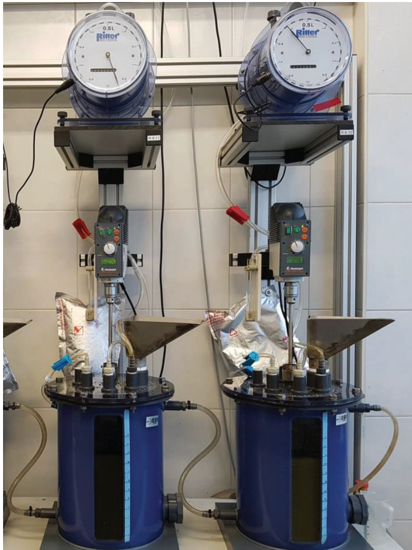
Abbildung 5: Laborfermenter. Unten: der stehende Rührkessel mit aufgebrachtem Fütterungstrichter. Oben: die Gasuhr
