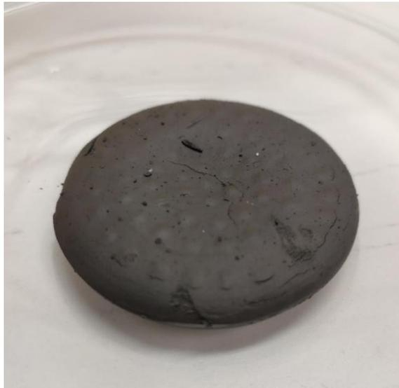
**Abbildung 28:** Oxidierte Kohlenstoffnanoröhren nach Behandlung mit Nitriersäure. Hydroxy- und Oxo-funktionalisierte MWNTs zeigten die gleiche Struktur. Alky-MWNTs lagen als Suspension vor.
