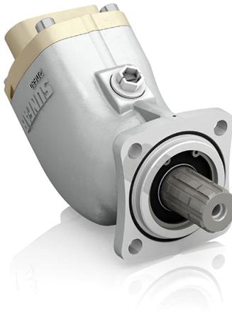
**Der SAM 010-130 DIN ist eine Serie von Axialkolbenmotoren mit leichtem Gehäuse, besonders geeignet für den Einsatz in der Mobilhydraulik. Der SAM 010-130 DIN ist ein Schrägachsenmotor mit sphärischen Kolben.**
