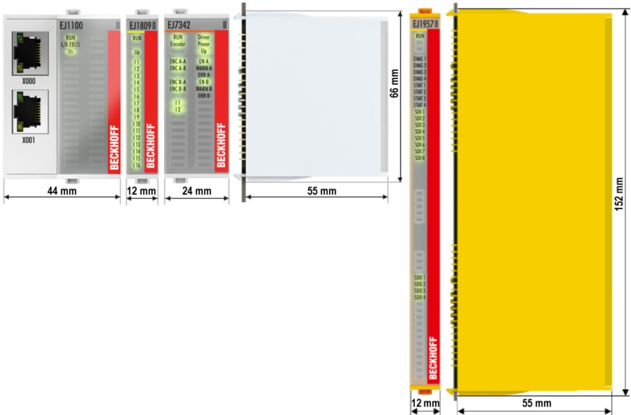
Abb. 12: EJxxxx - Abmessungen
