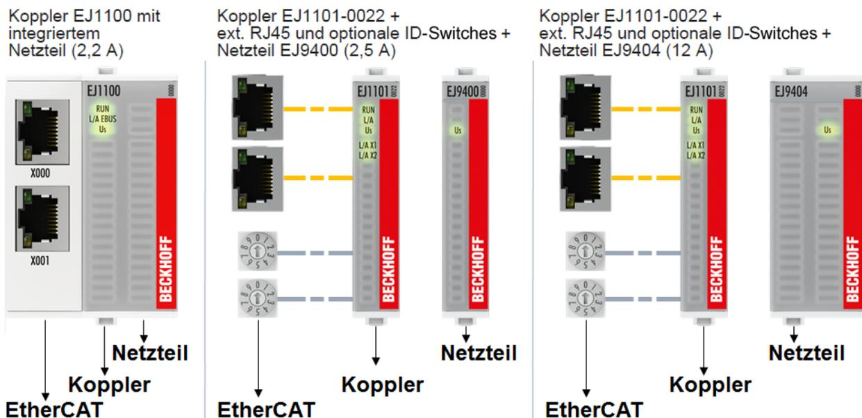
Abb. 10: E-Bus-Spannungsversorgung mit EJ1100 oder EJ1101-0022 + EJ940x
