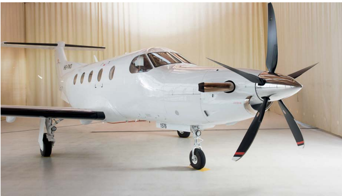
Das Trainingsflugzeug Pilatus PC-12 wird von einem Turboprop-Triebwerk angetrieben Bild: Pilatus Aircraft Ltd
