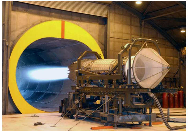
Pratt & Whitney F119 Turbofan mit Nachbrenner im Testbetrieb
