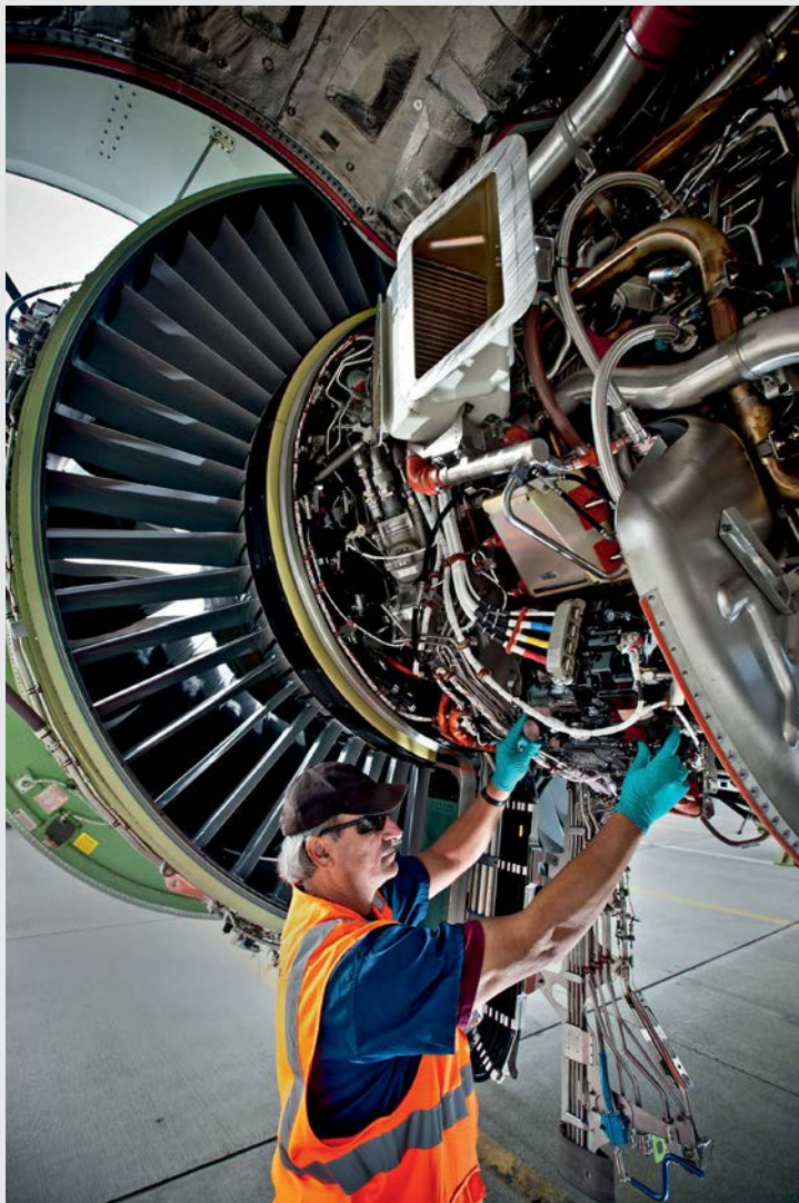
Vor der Montage an einer Boeing 777 wird das Strahltriebwerk GE90-115B gemeinsam mit Technikern von Boeing und General Electric ersten Betriebstests unterzogen
