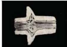
Seigerungen Profil im Kopf einer Schienenschraube
