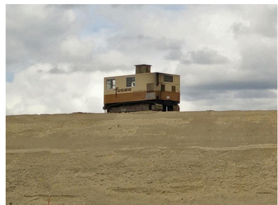
Abbildung 4.3: Drucksonde der Firma Fugro
