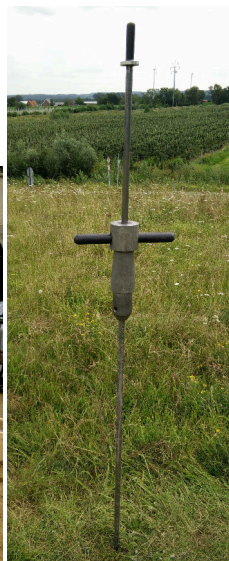
Abbildung 4.1: Sondierung mit der leichten Rammsonde (links pneumatisch, rechts handbetrieben)
