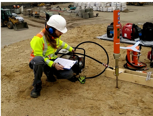
Abbildung 4.1: Sondierung mit der leichten Rammsonde (links pneumatisch, rechts handbetrieben)
