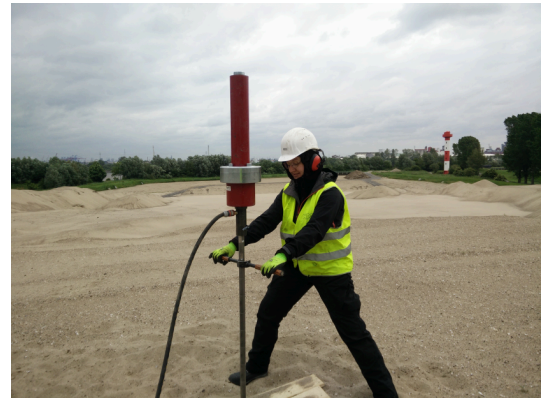
Abbildung 4.2: Sondierung mit der PR35, hier mit Zusatzgewicht als DPH
