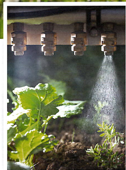
Das ARA-Präzisions-Sprühgerät ermöglicht das sogenannte „Spot-Spraying“, eine Einzelpflanzenbehandlung
