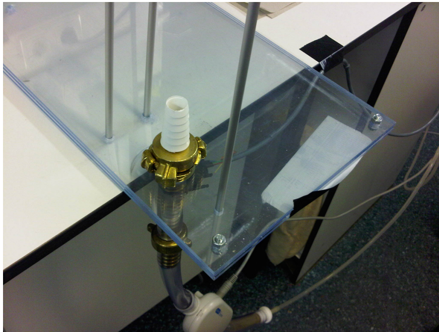
Abb. 5: konischer Adapter, auf dem die Kehlköpfe platziert wurden
