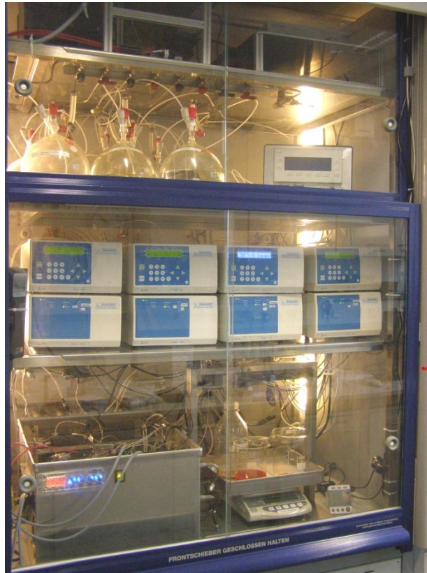
Abbildung 39: Foto des Flussreaktors im Laborabzug
