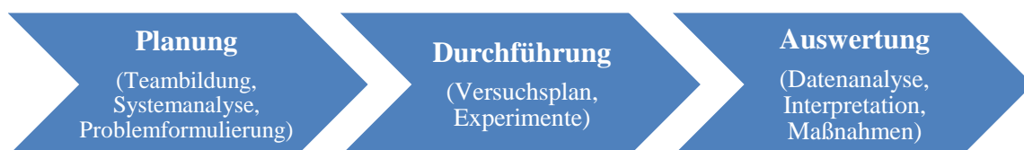
Abbildung 32: Genereller Ablauf eines Experiments in der statistischen Versuchsplanung
