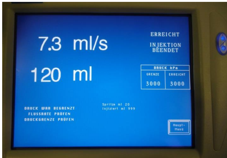
FIG.14. Anzeige der Flussrate auf dem Monitor bei einer Druckbegrenzung von 3000 kPa
