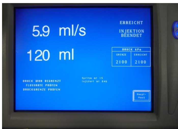
FIG.13. Anzeige der Flussrate auf dem Monitor bei einer Druckbegrenzung von 2100 kPa
