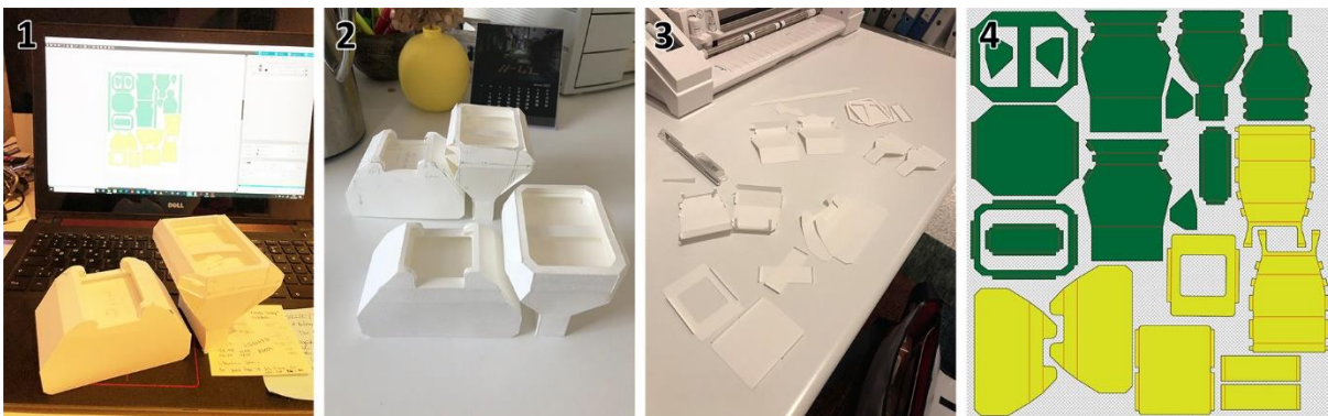
Abbildung 53: Erstellung der Papiermodelle für die Vielfachzapfenterminalen. (1) Erste Iteration der Vektordateien mit den ersten Papiermodellen (2) Erste (hinten) und Dritte (vorne) Iteration der Papiermodelle. Deutlich erkennt man die, im Vergleich zur kastenförmigen ersten Version komplexer geformten Modelle – mit dem Ziel, das diese in allen Achsen gut aneinanderpassen. (3) Geschnittene Einzelelemente der beiden Basismodelle, zum Teil schon in Form gefaltet. (4) Endgültige Vektorgrafik für die Modelle der Terminalen der kurzzapfigen ( grün ) und der langzapfigen ( gelb ) Photorezeptoren.
