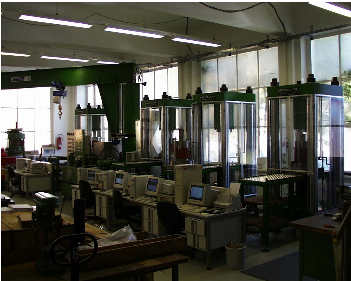
Bild 4.8: Triaxialprüfanlagen am Lehrstuhl für Deponietechnik und Geomechanik
