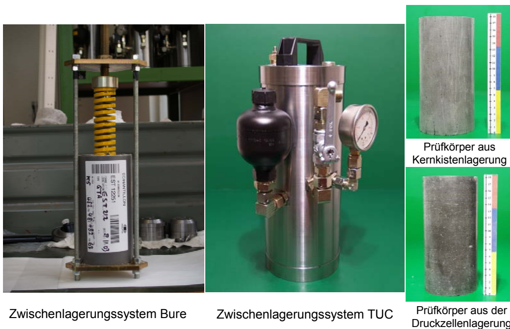
Bild 4.48: Zwischenlagerungssysteme für Tongestein
