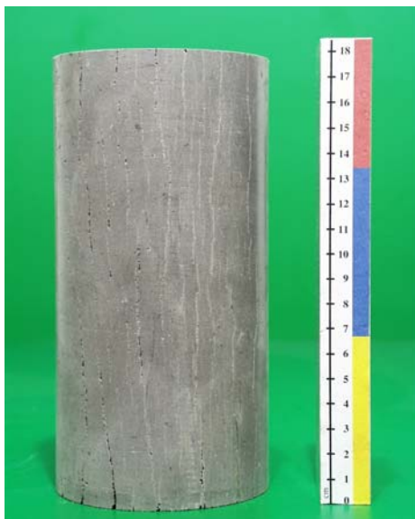
Nach Entnahme aus Kernkiste nach kurzer Lagerung (6 Wochen)
