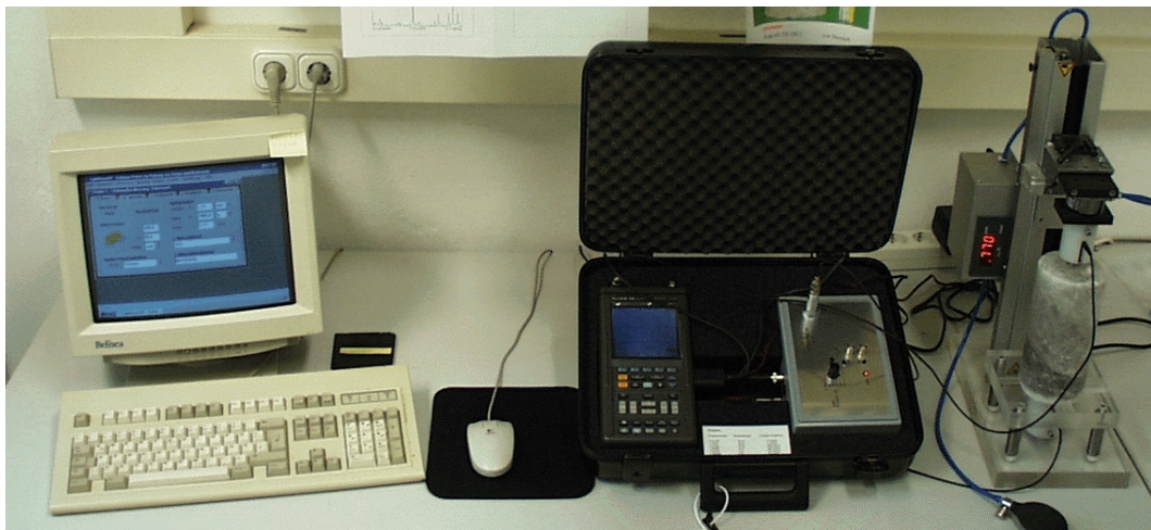
Bild 4.7: Dehnmessplatz am Lehrstuhl für Deponietechnik und Geomechanik
