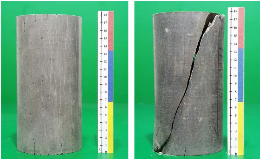
Bild 4.5: Tongesteinsprüfkörper vor und nach der Versuchsdurchführung mit Belastung parallel zum Schichtungsverlauf
