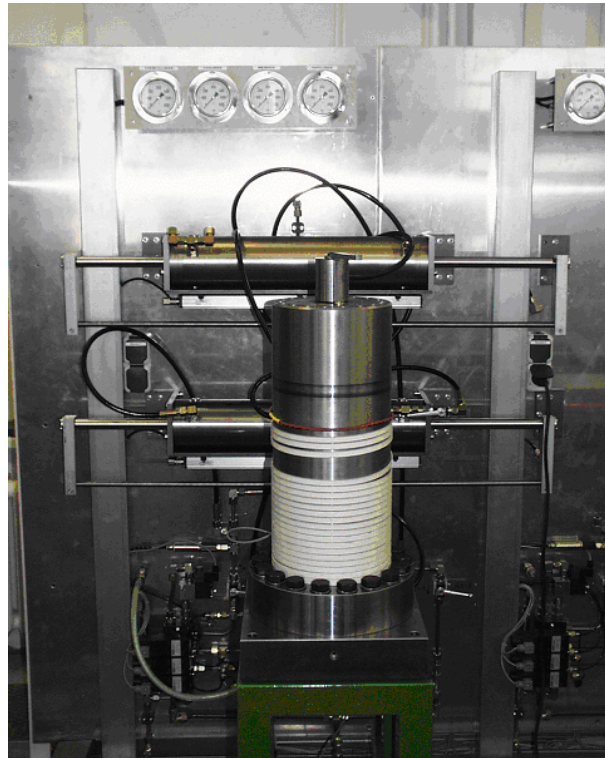
Bild 4.1: Triaxialzelle für Dauerstandversuche
