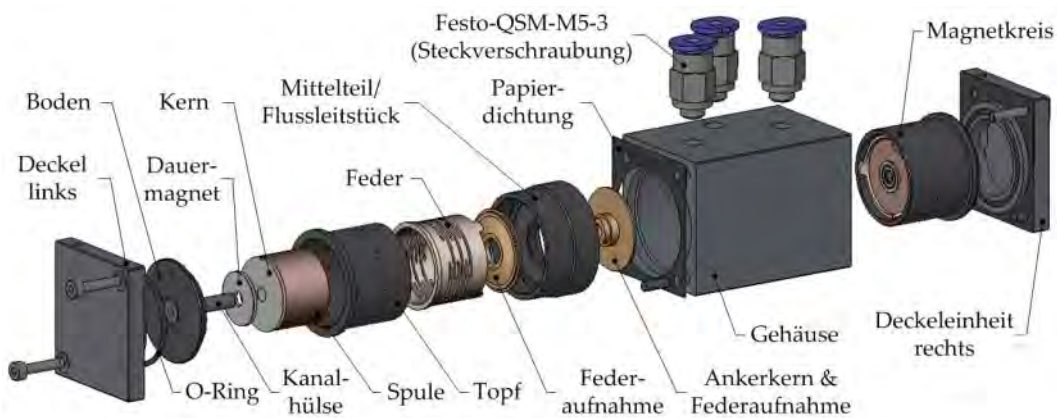
Abbildung 34: Explosionszeichnung des Funktionsmoders RMV3
