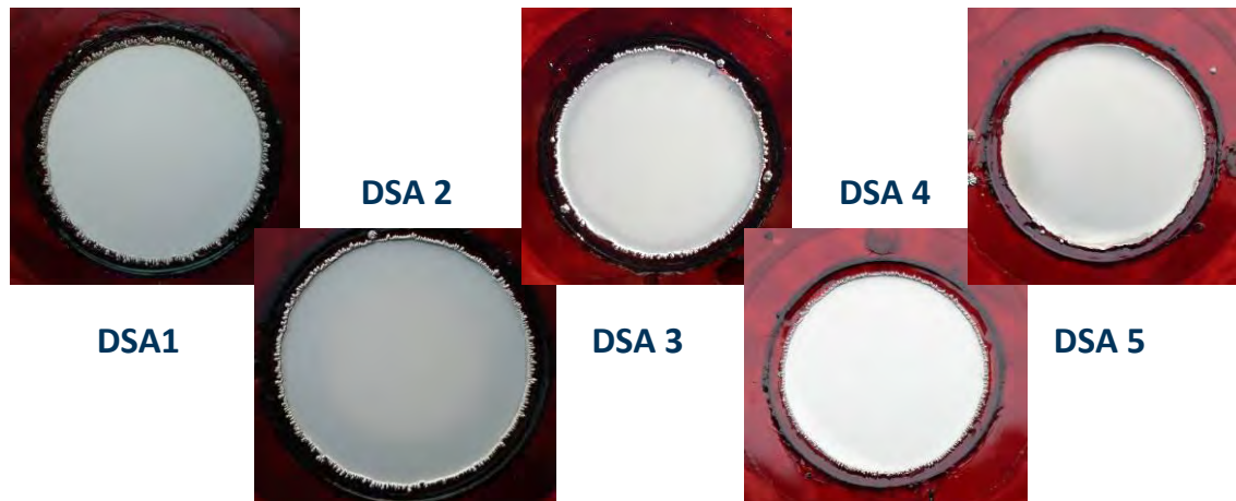
Abbildung 58: Abscheidung von Nickelschichten auf einem titanbeschichteten Wafer (Durchmesser 80 mm) unter Variation der Stromdichte
