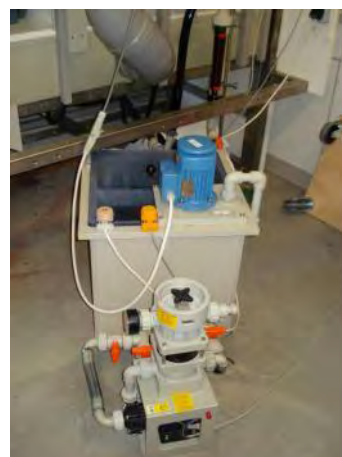
Abbildung 51: Konzipierte Elektrolyt Vorratsbehälter mit Filtereinrichtung
