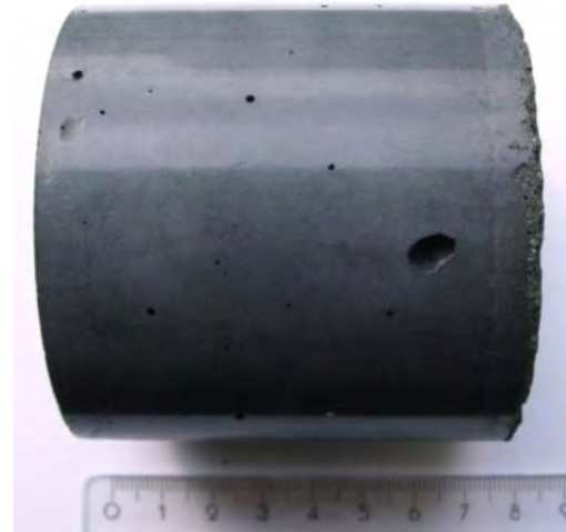
Abbildung 20: Kurze SVB Gussprobe mit Schwarzpigment und 5x7 mm 2 Lufteinschluss
