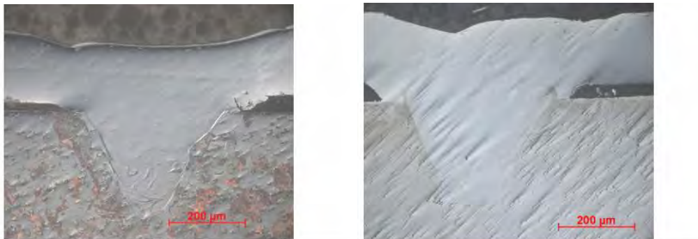
Lichtmikroskopische Querschliffaufnahme Laserschweißnaht Durchschweißung Probe 43 c
