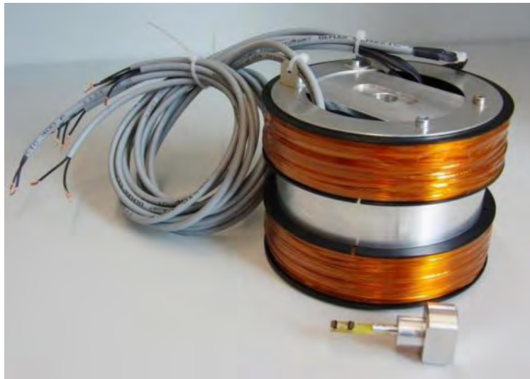
Abbildung 90: Prüfvorrichtung zur Vermessung dreiachsiger Magnetfeldsensoren
