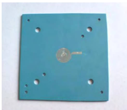
Abbildung 46: Gefertigte LTCC-Magnetisierungsspule (links), Detailansicht (rechts)
