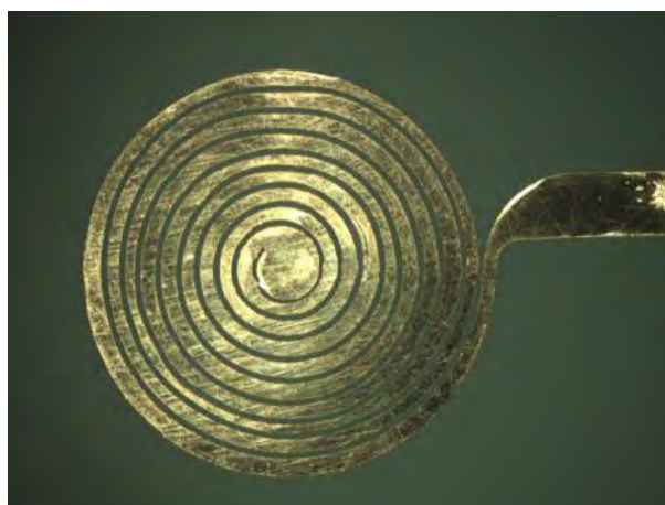
Abbildung 46: Gefertigte LTCC-Magnetisierungsspule (links), Detailansicht (rechts)
