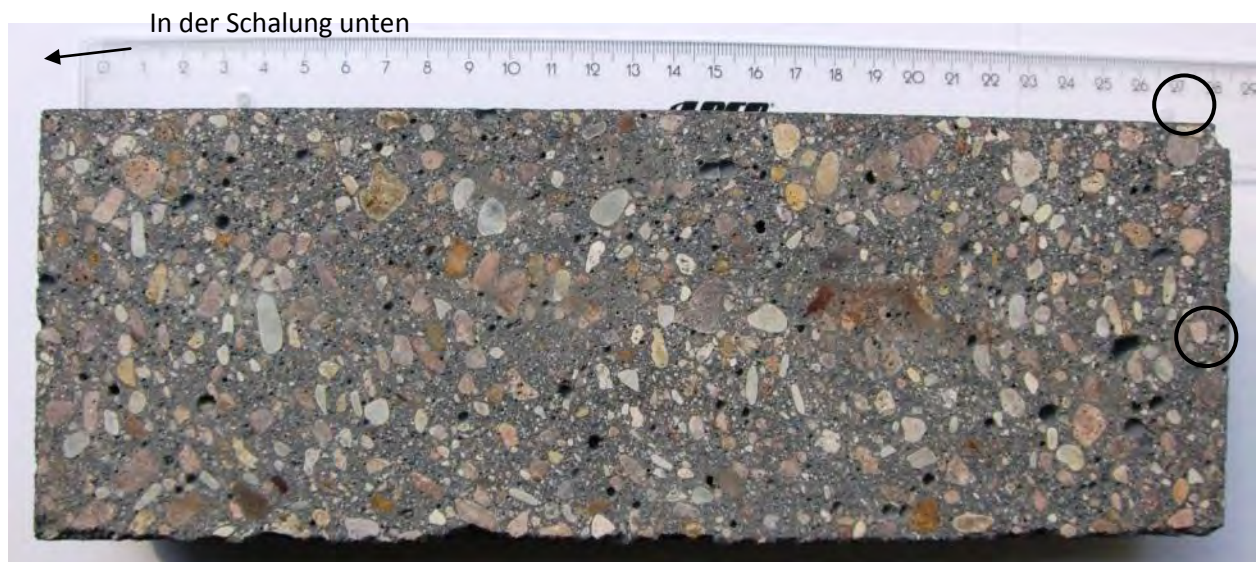
Abbildung 22: Schnitt der langen SVB Gussprobe mit Schwarzpigment zur Darstellung der Lufteinschlüsse in drei Regionen im Längsschnitt, keine Entmischung der Gesteinskörnung
