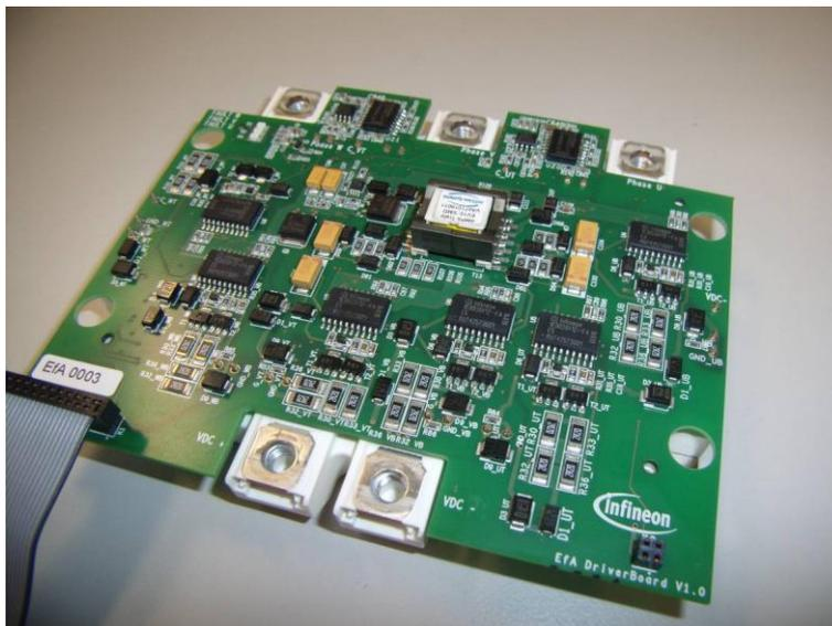
**Abbildung 46: Treiberelektronik mit Coreless Transformer Treiber IC und Sigma Delta Analog Wandler**
