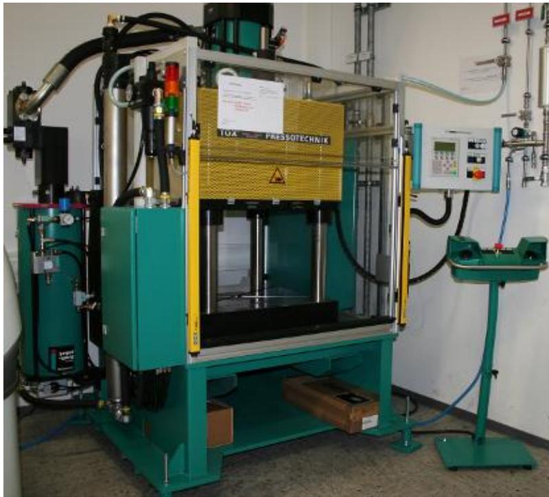
**Abbildung 55: Bild der Presse für den Sinterprozessschritt**
