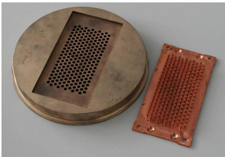
**Abbildung 57: Werkzeug für Aufnahme der PinFin Bodenplatten für die Drucksinterung**
